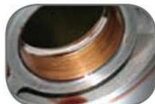
برای ترازنگاه داشتن دقیق محور پمپ‌ها از یاتاقان‌های برنزی که به قدر کافی بلند هستند، استفاده شده است. یک شیار مخصوص رونگکاری در هر یاتاقان ایجاد شده تا گردش ثابت روغن را روی سطح یاتاقان‌ها میسر سازد، این خصوصیات با ترکیب یکدیگر کارکرد نرم و با اطمینان و بی‌صدای پمپ را تضمین می‌کنند.
